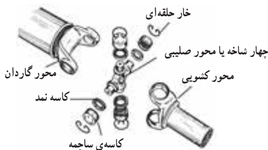
شکل ۲۹۱- اجزای قفل گاردان
